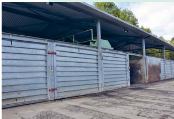
Kompostierboxen, die ideale Bedingungen für die Heissrotte bieten. Le compostage en boxes offre les conditions idéales pour une décomposition thermophile.
