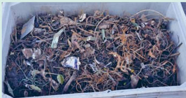
Von Magneten entfernte Metalle. Déchets ferromagnétiques retirés grâce à des aimants.
