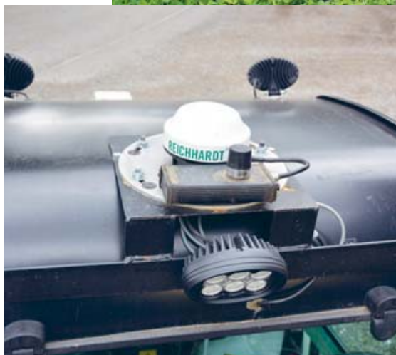
GPS-Empfänger auf dem Dach des Geländefahrzeugs. Le récepteur GPS situé sur le toit du véhicule tout-terrain.
