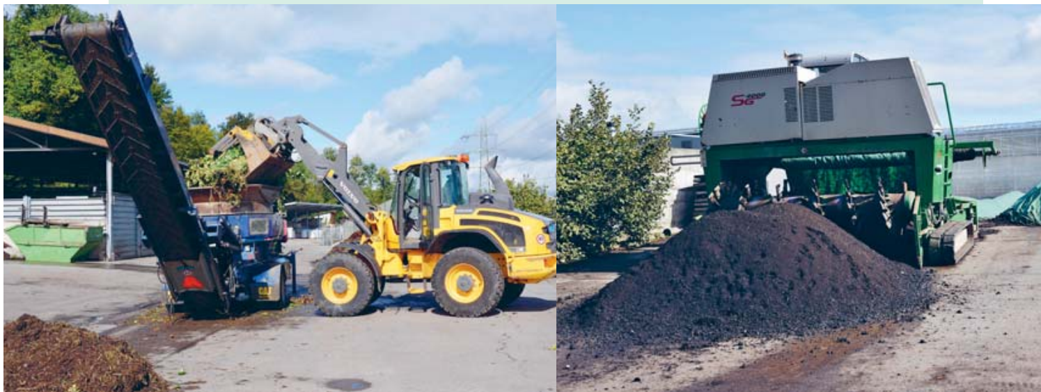
Demonstration für die Veranstaltung «vo puur zu puur» die zeigt, wie mit professionellen Geräten aus Grüngut Qualitätskompost produziert wird. Démonstration lors de l'événement intitulé «du paysan au paysan» montrant comment on peut produire du compost de qualité à partir de déchets verts grâce à un équipement professionnel.
